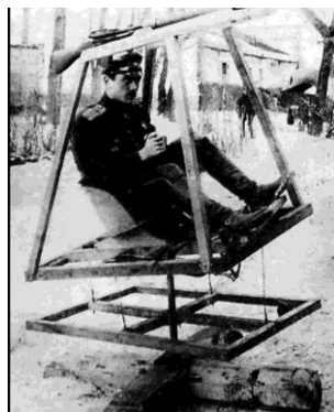
Корнет Гильшер на сконструированном им тренажере. Зима 1916-17 годов.
